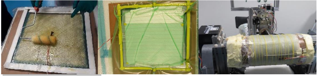
Figura 2. Pruebas laboratorio con sensores DC y FBG (izda.: laminación manual, centro: infusión, dcha.: filament winding).
